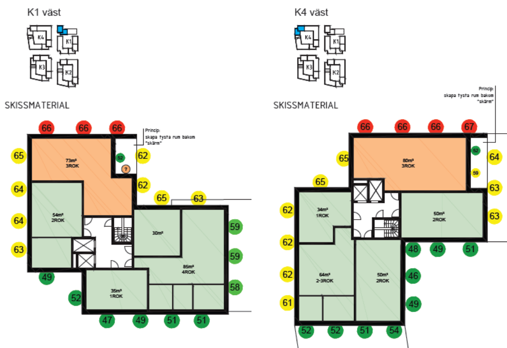
Illustration av trafikbuller i de högdelar som utsätts för trafikbuller från Oscarsleden/Älvsborgsbron. Förslag till lägenhetslösningar som kan ge bullerutsatta lägenheter (orange) möjlighet till skärmning som ger tillgång till ljuddämpad sida mot balkong.
